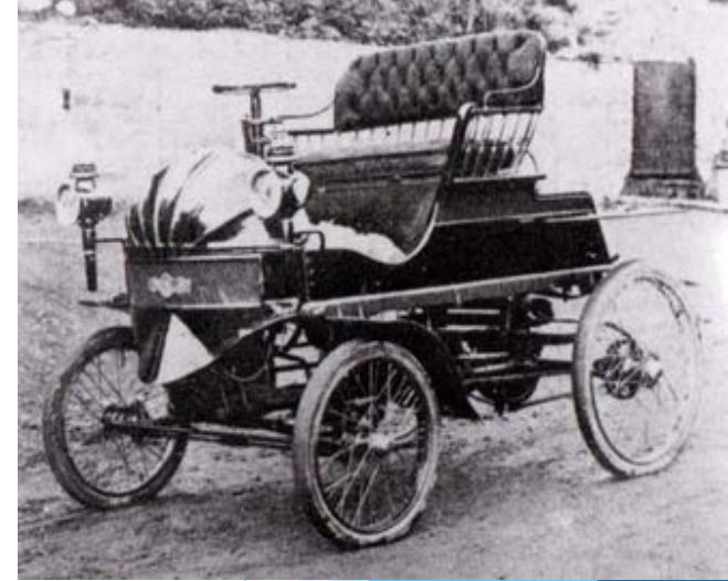
Automobile Pieper en 1900 avec une propulsion essence-électrique
